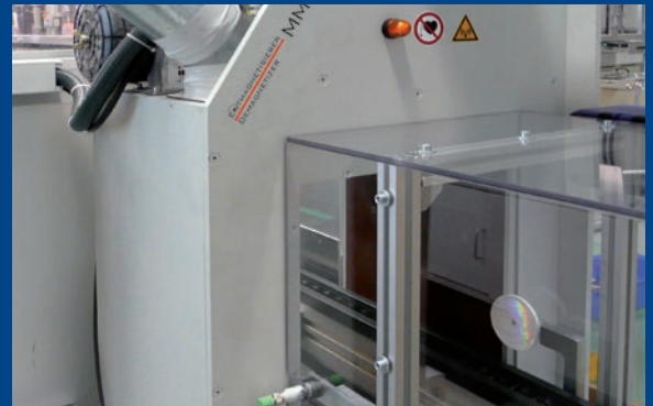
MM VE mit integrierter Lichtschranke zur Pulsauslösung. Die Anlage arbeitet dadurch völlig automatisch.
