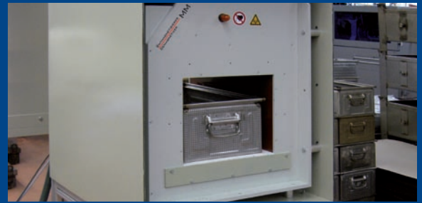
«Magnetische Reinigung» von 500 Federn im Edelstahlbehälter 480x320x210. Das Spulenmodul MM VE ist mit einer Magnetfeldabschirmung versehen.
